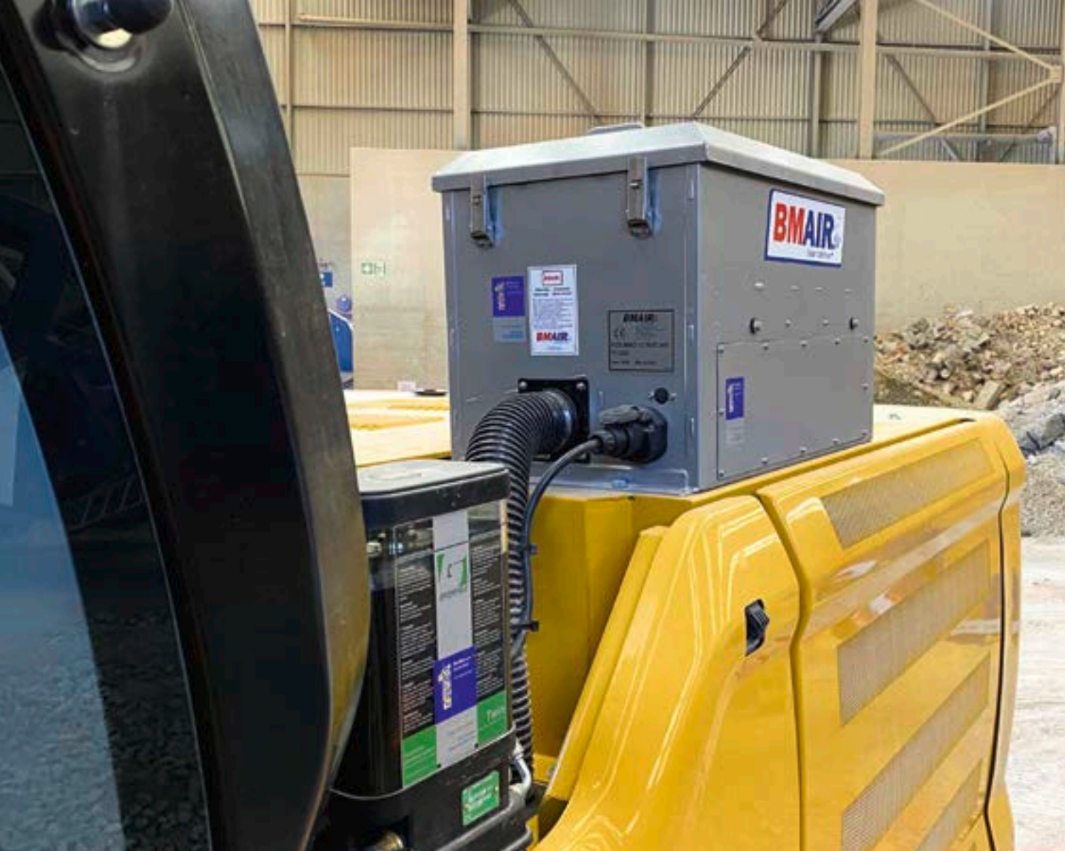
Schmieranlagen und Schutzbelüftungsanlagen
