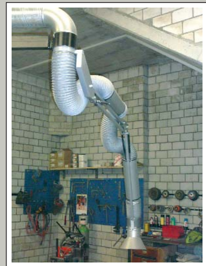
Ausleger mit Absaugarm NW 160 mit Rohren, außen liegendem Gestänge und Hydraulikdämpfern.
