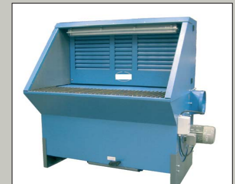
Schleiftisch mit Unter- und Hinterwandabsaugung mit integriertem Ventilator und Patronenfilter für den Umluftbetrieb.
