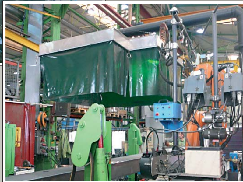
Roboterabsaugung über eine verfahrbare und schwenkbare Absaughaube mit SSK 290 und zentraler Patronenfilteranlage.
