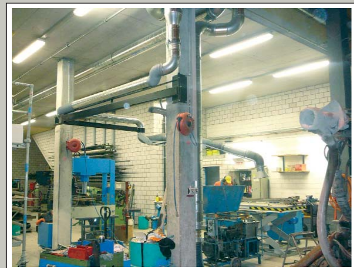
Hochflexibler Auslegerarm VARIO Flex NW 160 – 9 m lang, mit 3 Drehgelenken, montiert auf einer Säule zum Abdecken von 4 Arbeitsbereichen.
