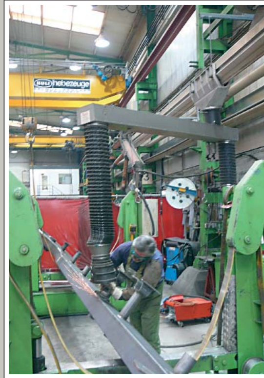
Mitteldruck-Schweißrauchabsaugung mit SSK 290 - 12 m lang mit einem Laufwagen und Teleskopausleger für Schweiß- und Schleifarbeiten an langen Werkstücken.
