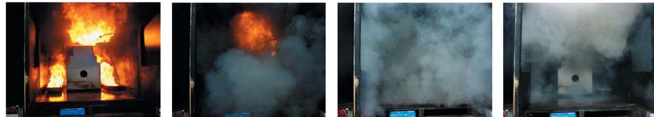
Die Bilder wurden in einem Intervall von 4 Sekunden aufgenommen. Der Temperatur fällt innerhalb von 12 sek. von 400°C auf 40°C. Während diesen 12 Sekunden, wurde ungefähr 7,5 dl Löschmittel versprüht.
