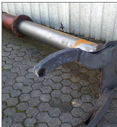
Ausgebauter alter Kolben mit Aufnahme
