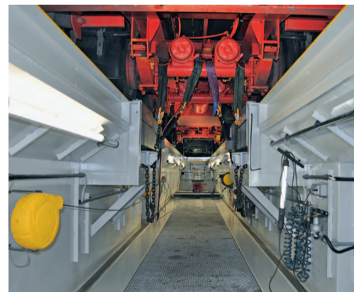
Photo de gauche: cric de fosse Pitlift avec play detector Altus
