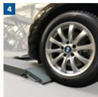
**1** Um eine flexible Aufnahme sowohl kleiner als auch großer Fahrzeuge zu ermöglichen, besitzt die XS30N / XS30N-CAT beidseitig ausklappbare und leicht arretierbare Plattformverlängerungen.
