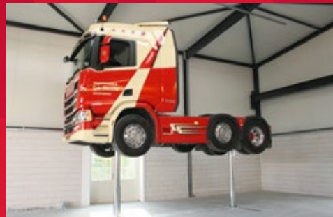
Stempelanlage mit min. einem festen und einem querverfahrbaren Hubstempel
