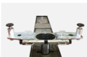
Querverstellbare Standardtraverse mit optionalen Zusatzadaptern
