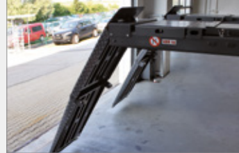
Klapp-Auffahrrampe bei hohen Fahrflächen oder geringem Auffahrwinkel
