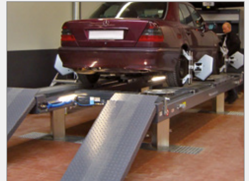
Hohe Genauigkeit als Achsmesshebebühne.
