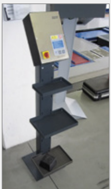
Steuerung auf einer Funktionsstandsäule, zu freien Aufstellung montiert
