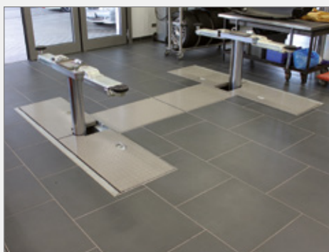
Öffnen und Schließen der Abdeckung wird durch ein pneumatisches Dämpfersystem unterstützt
