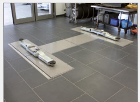
Die Hebebühne kann mit geschlossener Abdeckung als Standard-Hebebühne genutzt werden
