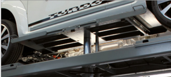
Fahrflächen-Hebebühnen mit Plattform-Radfreiheber, Schwelleraufnahme Traglast 3,5 t
