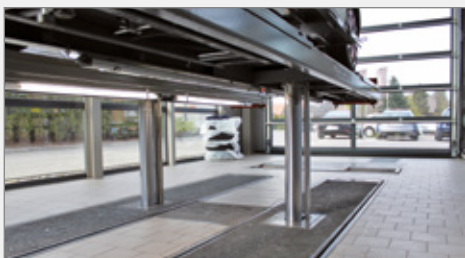
Einbaurahmen für Fahrflächenvarianten mit und ohne Bodenausgleich zum genauen Einpassen der Hebebühne. Durch die vorgefertigten Einfassungsrahmen wird beim Einbau eine hohe Genauigkeit erreicht.
