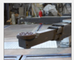
Unterschwenkhöhe am Aufnahmeteller von 123 mm
