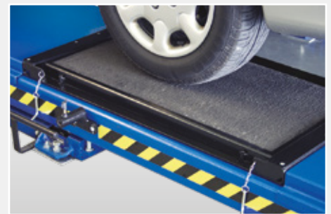
Schiebeplatte mit möglicher Drehbewegung +/- 5° und einer Seitenbewegung von +/- 50 mm
