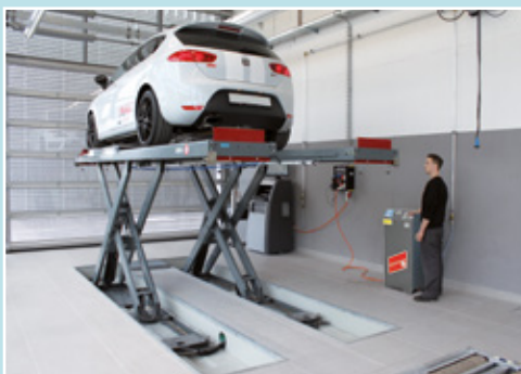
Durch die große Hubhöhe von ca. 2100 mm ideal für den Einbau in ein Streifenfundament. Nutzbare Hubhöhe bei dieser Einbauart min. 1850 mm
