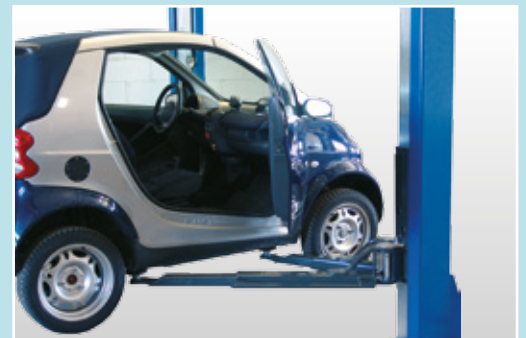
Weite Türöffnung durch asymmetrische Fahrzeugaufnahme
