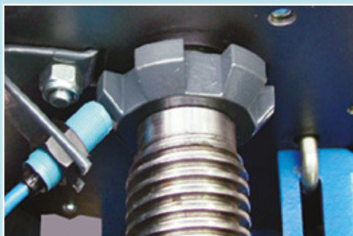
Verschleiß- und wartungsfreie Induktivgeber für die berührungslose Höhenerkennung
