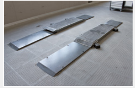
Überfahrampen: Dadurch verringert sich die Überfahrhöhe der bodenauflegend montierten Hebebühne um 40 mm
