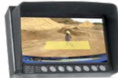
Réglage RadarEye : visualisation claire des zones radar à l'écran. (réglage standard prédéfini)
