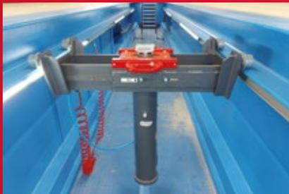
Querverstellbares Fahrwerk des Blitz S15 Vario-Grubenhebers deckt die gängige Grubenbreiten problemlos ab.
