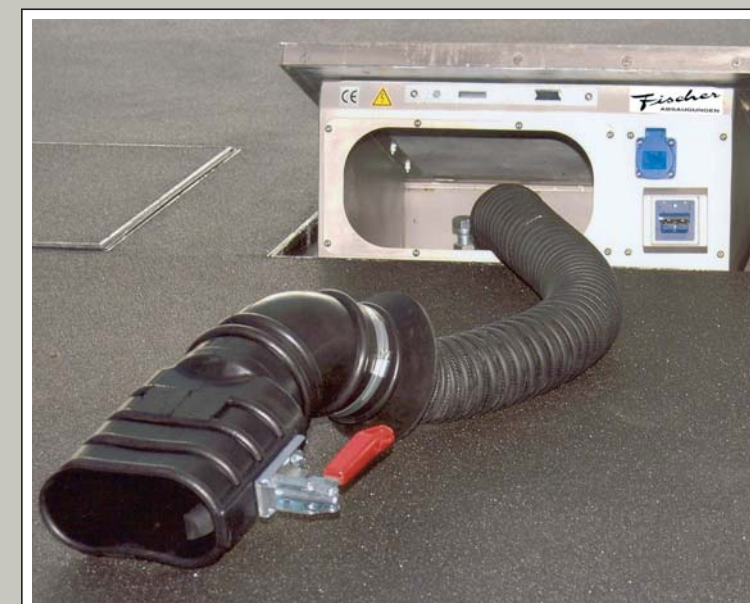
Unterflurabsauganlage mit versenkbarem Abgasschlauch, drehbarem Bogentrichter 60° und Aufstecktrichter mit Feststellklemmzange für Doppelrohrsauganlagen einschließlich Energieversorgung. Pneumatisch betätigt. Die Anlage wird als fertige Einbaueinheit mit Hochtemperaturrohrleitung für die Sticheleitungen geliefert und an einem Zentralventilator Typ FD angeschlossen.
