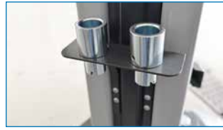
Ablageblech für Aufnahmetellererhöhungen.
