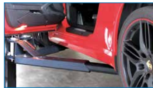
Sportwagentragarme Unterschwenkhöhe 80 mm (MA STAR 3.5 A Comfort)
